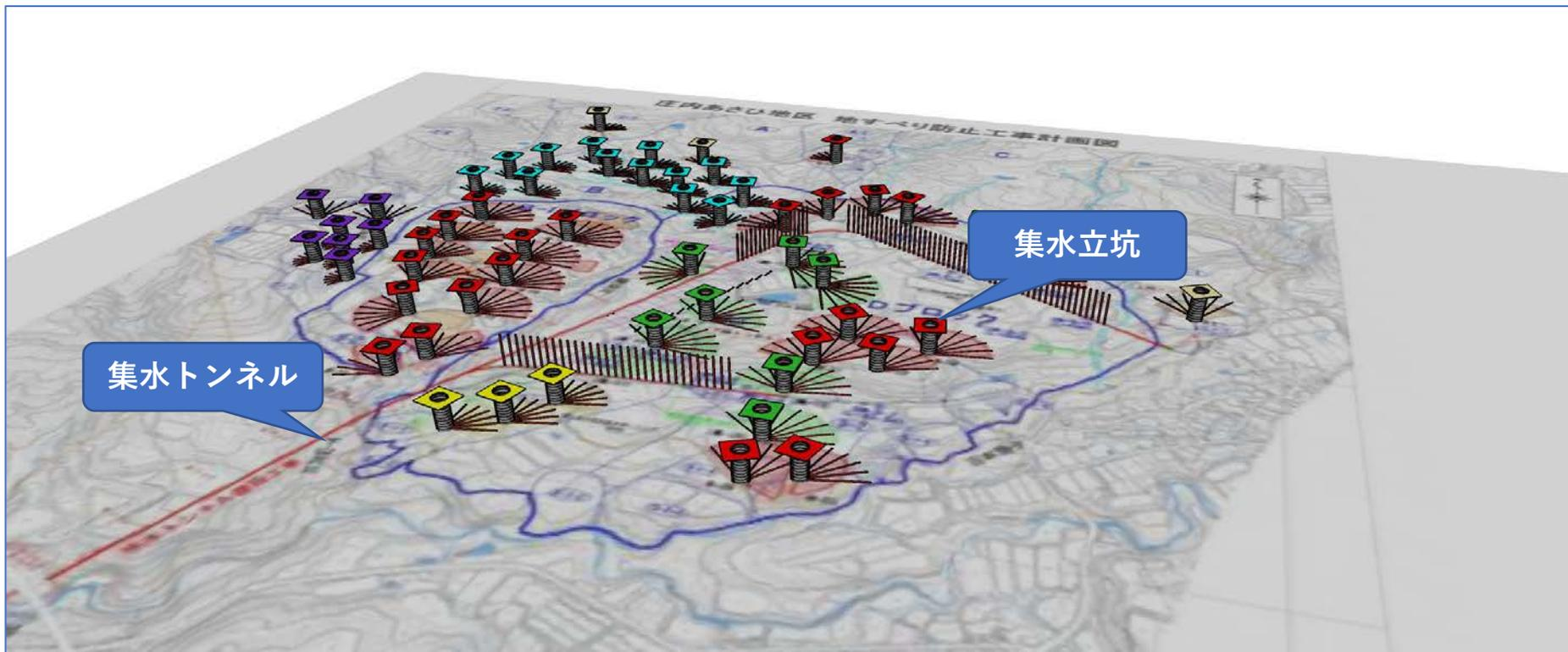
地下水集水トンネル及び立坑情報の3D管理
